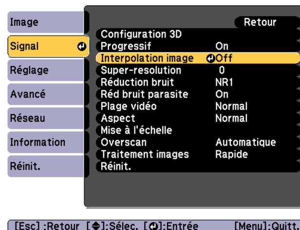
Vous pouvez sélectionner le niveau d'interpolation : **Bas**, **Normal** ou **Haut**. Réglez-le sur **Off** si du bruit se produit une fois le réglage de l'interpolation effectué.
